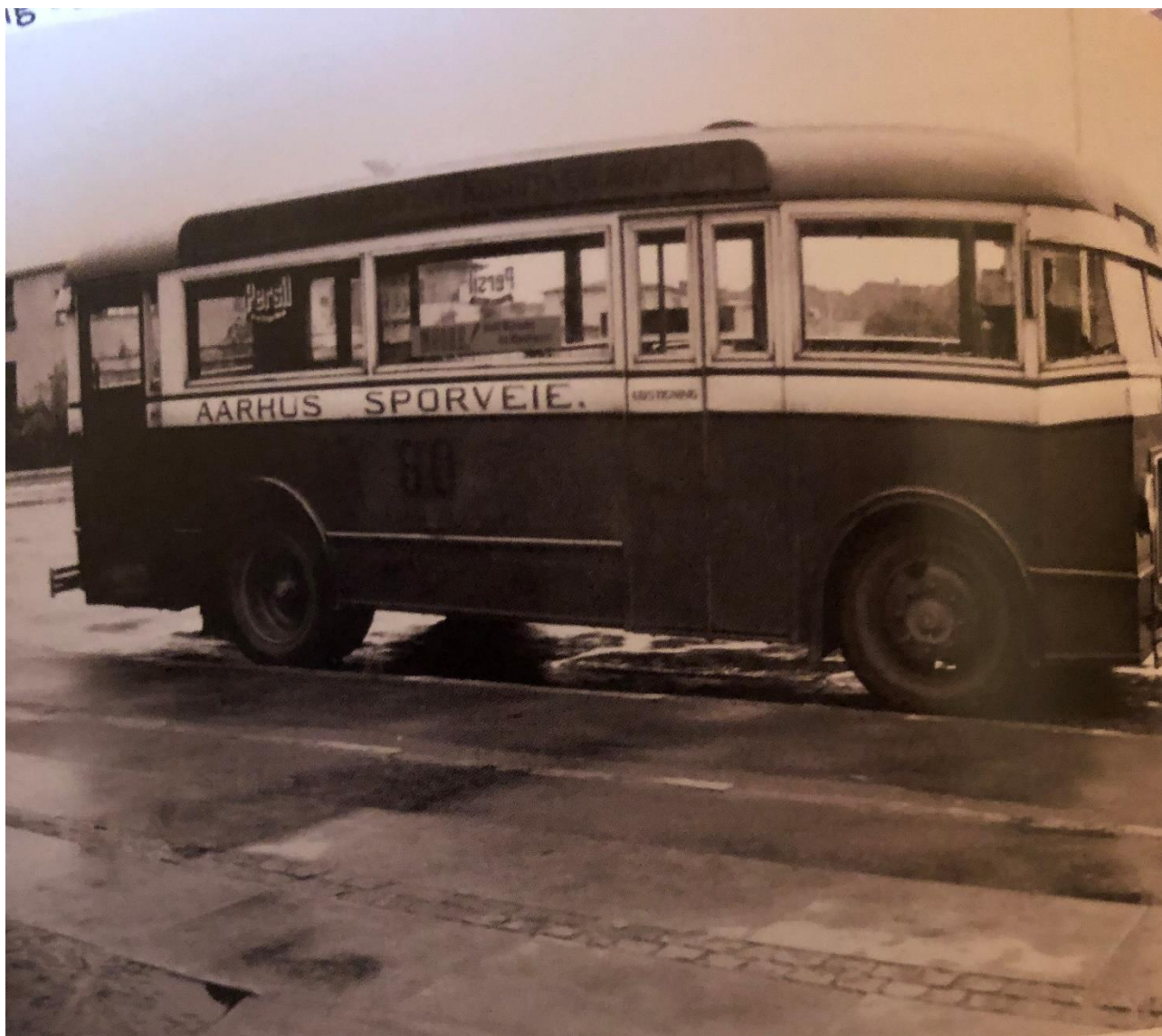
Aarhus Sporveje indsatte i 1932 de første såkaldte trambusser bygget af Triangelfabrikken i Odense. Det firkantede buskarosseri var dominerende indtil 1959erne. (Foto Svend E. Ersgaard.)
